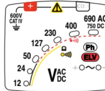
Es kann vorkommen, dass der Spannungsprüfer eine Betriebsspannung am Prüfling anzeigt, wenn nahe am Prüfling eine Störspannung vorhanden ist.
