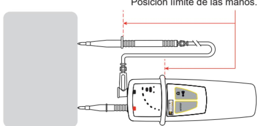
Coloque las puntas de prueba sobre el elemento a probar y mantenga firmemente el contacto.
