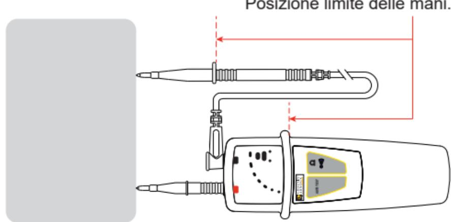
Posizionate le punte di contatto sull'elemento da testare e mantenete fermamente il contatto.
