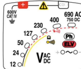
In caso di una tensione perturbatrice vicino all'elemento testato, lo strumento può indicare la presenza di una tensione di servizio sull'elemento testato.
