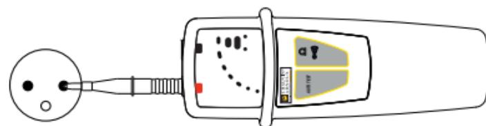
Si la punta de prueba está en contacto con la fase, el piloto **Ph** (fase) parpadea y el instrumento emite señales acústicas.
