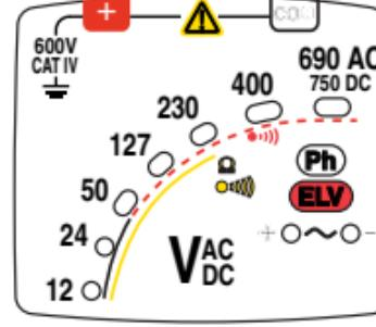
En caso de una tensión parásita cerca del elemento probado, el instrumento puede indicar la presencia de una tensión de servicio en el elemento probado.
