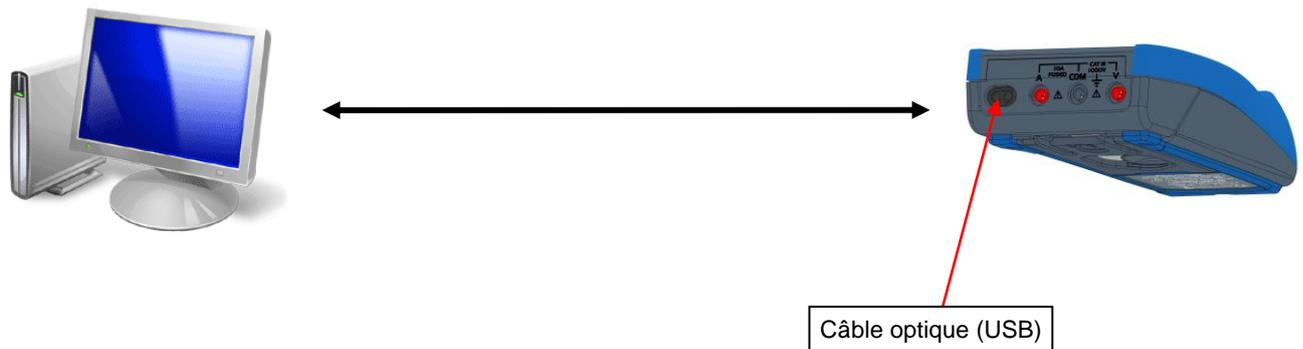
Si votre appareil dispose de l'option Bluetooth et que votre ordinateur en est équipé ou dispose d'une clé Bluetooth, vous pouvez utiliser le port com virtuel créé après connexion pour programmer à distance votre instrument, de la même façon qu'avec un câble USB/optique
