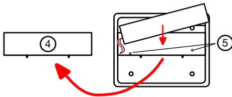
5. Den Akku etwas anheben (nicht an den Drähten ziehen!) und die beiden Schrauben am Boden des Akkufachs lösen. Akku anschließend wieder hineinlegen.
