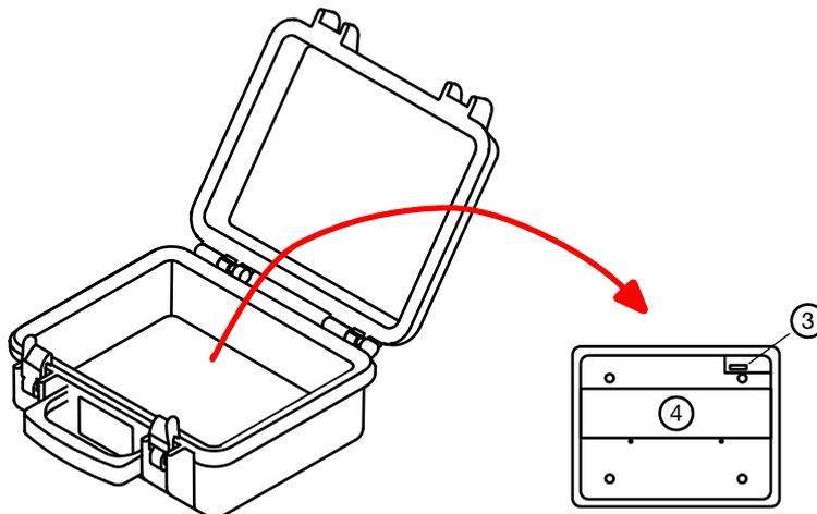
4. Wenn nur die Sicherung der Buchse H zu ersetzen ist, lesen Sie direkt unter Punkt 9 weiter. Wenn auch die Sicherung des Zangeneingangs ES ausgewechselt werden muss, lösen Sie die beiden Schrauben des Akkufachs und öffnen Sie es.
