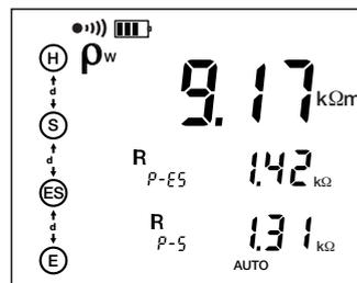
Im Erdreich liegende Metallteile (Bahngelise, Rohrleitungen usw.) oder Wasseradern können den Widerstand in einer Richtung stark beeinflussen. Daher empfiehlt es sich, die Ausrichtung der Erdspeie nach einer ersten Messung um 90° zu drehen, um Richtungseinflüsse zu erkennen, und erneut zu messen. Außerdem empfiehlt es sich, den Abstand  $d$  mehrmals zu verändern, um sicher zu gehen, dass keine lokalen Einflüsse die Messung verfälschen.
