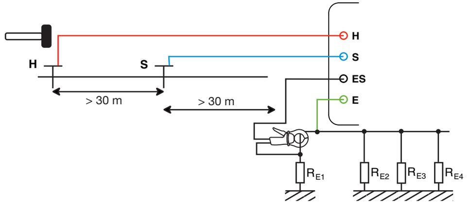
Um Beeinflussungen und induktive Effekte auszuschließen, sollten Sie die Messleitungen stets komplett von der Haspel abwickeln, und diese so weit wie möglich voneinander entfernt verlegen und ohne Schleifen auflegen. Vermeiden Sie außerdem zu große Nähe oder parallel zu metallischen Leitern (Kabeln, Schienen oder Metallzäunen).
