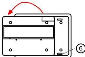
7. Den Geräteboden wieder an Gerätevorderseite und Elektronik anbringen, ohne an den Akkudrähten zu ziehen. Vor dem Einlegen des Bodens richten Sie die vier Bohrlöcher auf die vier Fixierstäbe aus. Achten Sie darauf, dass dabei keine Akkudrähte, Kabel oder Komponenten eingeklemmt oder abgequetscht werden.
