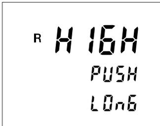
Diese Meldung erscheint dann, wenn der Messvorgang mit einem kurzen Druck auf START/STOPP gestartet wurde, die Widerstand der ErdspeÙe aber zu ist.
