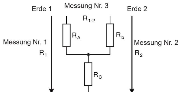
Nachdem Sie durch Druck auf CONFIG und mit Taste ► von EARTH auf EARTH COUPLING umgeschaltet haben, gehen Sie wie folgt vor:
