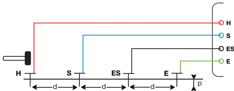
Um Beeinflussungen und induktive Effekte auszuschließen, sollten Sie die Messleitungen stets komplett von der Haspel abwickeln, und diese so weit wie möglich voneinander entfernt verlegen und ohne Schleifen auflegen. Vermeiden Sie außerdem zu große Nähe oder parallel zu metallischen Leitern (Kabeln, Schienen oder Metallzäunen).
