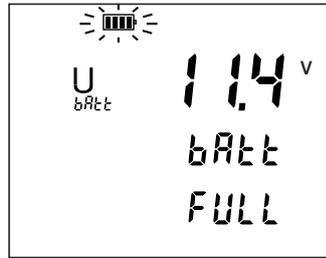
Nach längerer Nichtbenutzung des Geräts kann sich der Akku vollständig entladen. In diesem Fall dauert das Aufladen mehrere Stunden. Nach 3 bis 5 vollständigen Entlade-/Ladezyklen hintereinander erreicht der Akku seine ursprüngliche Kapazität wieder.
