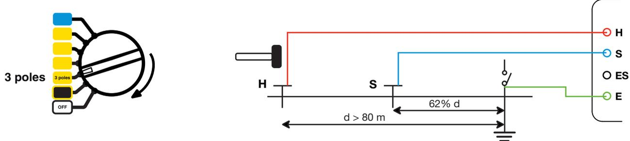
Um Beeinflussungen und induktive Effekte auszuschließen, sollten Sie die Messleitungen stets komplett von der Haspel abwickeln, und diese so weit wie möglich voneinander entfernt verlegen und ohne Schleifen auflegen. Vermeiden Sie außerdem zu große Nähe oder parallel zu metallischen Leitern (Kabeln, Schienen oder Metallzäunen). Nun schließen Sie die Leitungen an die Buchsen H und S, lösen die Potential-Ausgleichsschiene und schließen die Buchse E an den zu messenden Erder an.
