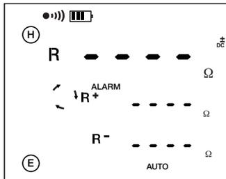
Das Gerät misst ein Mal mit Vorwärtsstrom (R+), kehrt dann die Stromrichtung um und misst erneut (R-)
