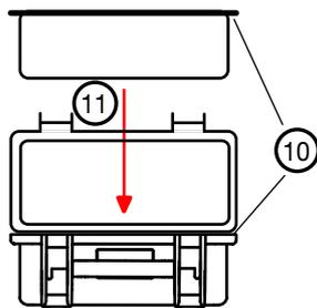
11. Das Innenteil wieder ins Gehäuse einlegen, den Deckel schließen und die Schrauben anziehen.
