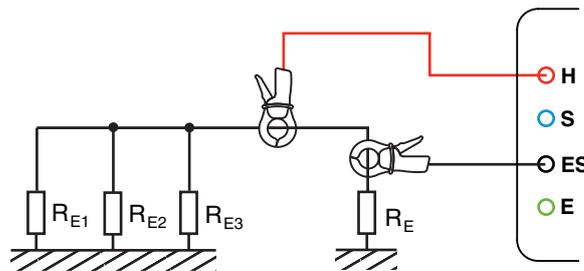
Halten Sie außerdem die folgenden Mindestabstände zwischen den Stromzangen ein, um elektromagnetische Beeinflussungen zwischen der „sendenden“ und der „empfangenden“ Stromzange zu vermeiden.
