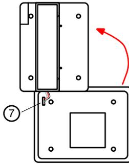
7. Den Stecker mit 4 Drähten abziehen, zum Abziehen des Steckers die Lasche am Stecker wegdrücken. Dabei Platte und Komponenten nicht mit den Händen berühren.
