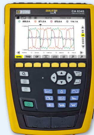
Pantalla 2: defecto con aumento de la corriente y activación del disyuntor
