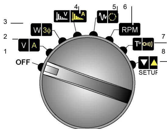
Figura 6: Visione delle modalità accessibili dal commutatore rotante.
