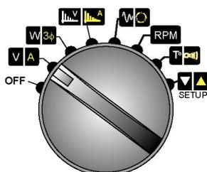
Figura 68: Il commutatore di funzione.
