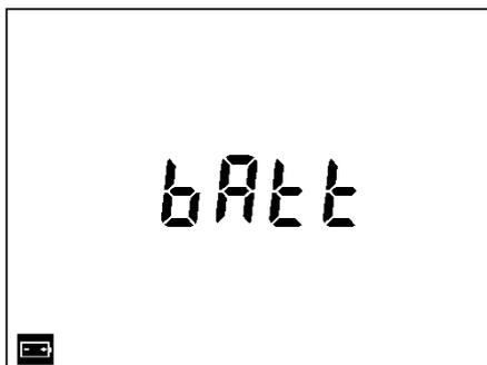
Figura 5: L'indicazione di batteria bassa che richiede una sostituzione.
