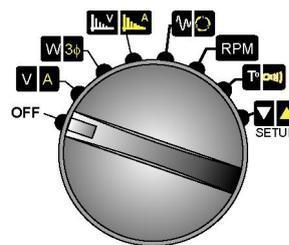
Figura 7: Il commutatore rotante in posizione OFF.
