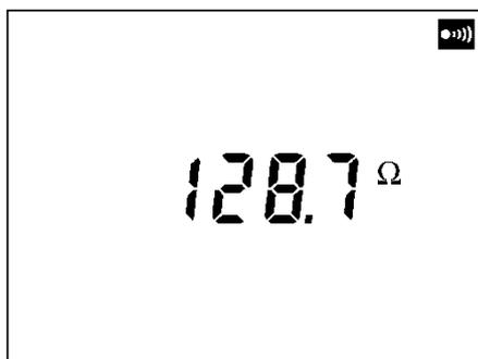
Figura 45: Esempio di una misurazione della resistenza.
