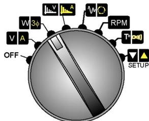
Figura 17: Il commutatore rotante in posizione **W**<sub>3Φ</sub>.
