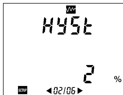
Figure 48 : Affichage du paramètre relatif à l'hystérésis.
