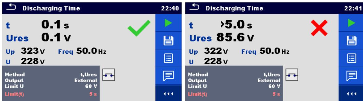
Abbildung 5.51: Beispiele für Ergebnis Entladezeitmessung (Anschluss = Extern)
