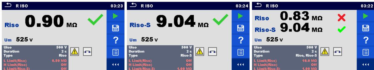
Abbildung 5.27: Beispiele für Ergebnisse der Isolationswiderstandsmessung
