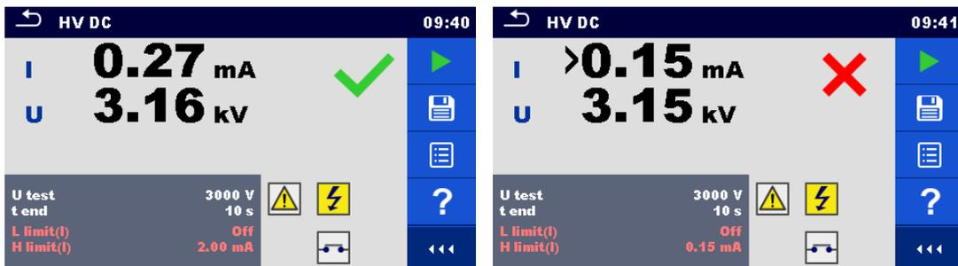
Abbildung 5.15: Beispiele für Ergebnisse der HV DC Prüfung
