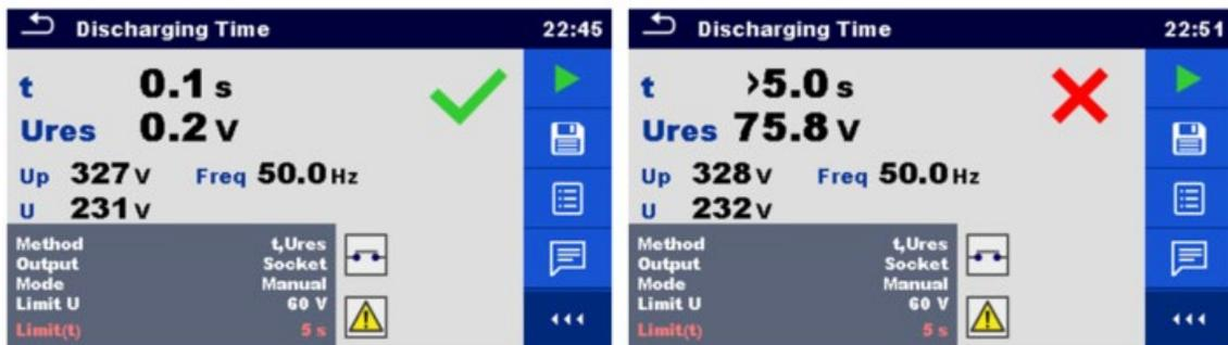
Abbildung 5.53: Beispiele für Ergebnis Entladezeitmessung (Anschluss = Prüfsteckdose)
