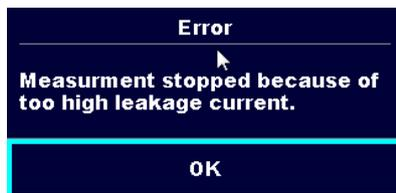
Die gemessenen Ableitströme (I<sub>diff</sub>, I<sub>pe</sub>, I<sub>touch</sub>) waren höher als 20 mA. Die Messung wurde abgebrochen Drücken Sie **OK** um fortzufahren.
