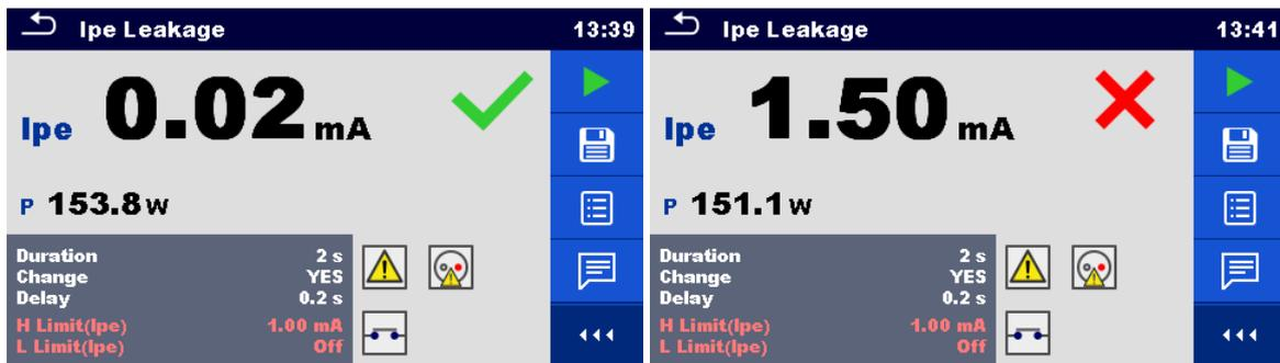
Abbildung 5.38: Beispiele für Ergebnisse Ipe Schutzleiterableitstrom Messung
