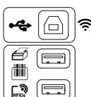
ช่องเสียบ USB Type B เพื่อเชื่อมต่อกับเครื่องพิมพ์เพื่อทำการถ่ายโอนข้อมูลที่บันทึกไว้หรือเพื่ออัปเดตเฟิร์มแวร์
