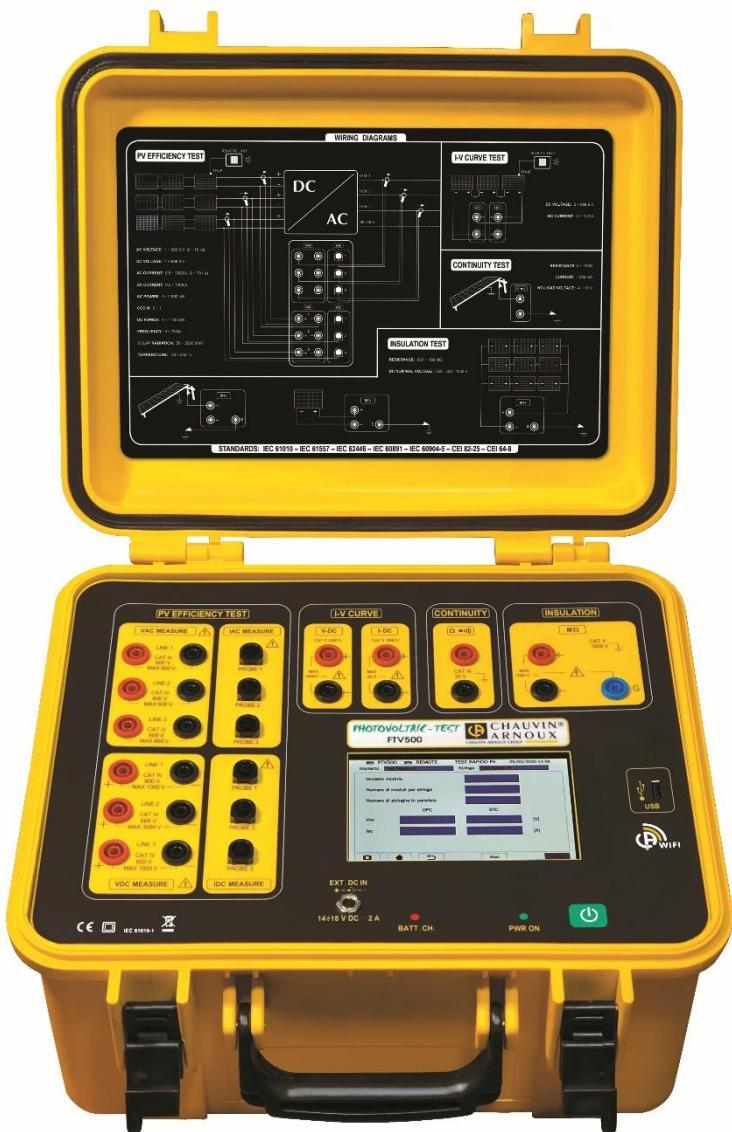
**Testeur multifonctions pour systèmes photovoltaïques**
